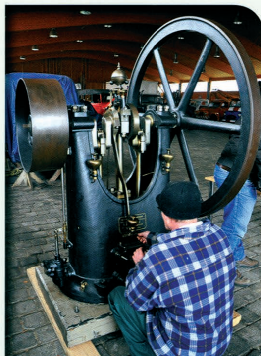
▲ Een allereerste inspectie liet zien dat de motor van 1881 nog in een prima staat bevond, weliswaar met gebruikssporen maar niet versleten. Een supermooie machine van een zeldzaam mooie kwaliteit, alles is degelijk gemaakt en wel geproportioneerd.
