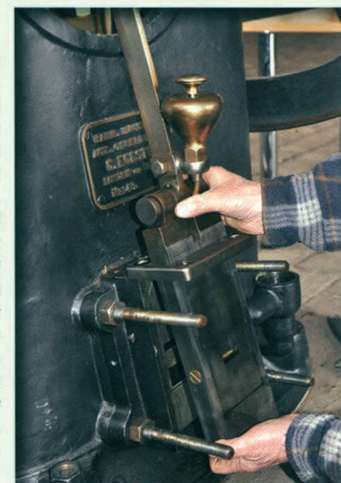
► Het afnemen van de schuif die toegang geeft tot de werkcilinder. Middels een ingewikkeld kanalsysteem wordt de lading ontstoken door een vlam die buiten de motor brandt. Men spreekt ook wel van open vlam ontsteking. Dit is een belangrijk deel van het goed functioneren van de motor. De vlakken van deze schuif dienen goed vlak en schoon te zijn, de motor had er wat sleet en de motor ontstak soms met het lichten van de schuif hetgeen resulteerde in een flinke rookwolk en het doven van de ontstekingsvlam. Vlug weer aansteken en de motor blijft lopen. Maar zover was het nog niet.
