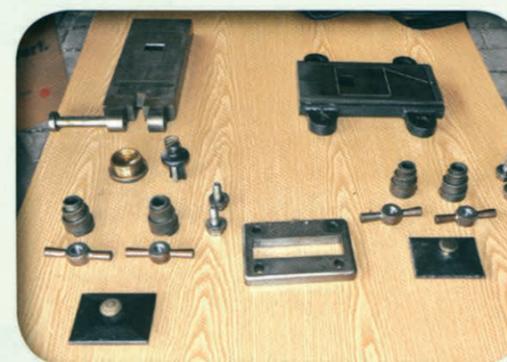
◀ De schuif met deksel en toebehoren. Het geheel is demontabel en goed toegankelijk want het moest regelmatig schoongemaakt worden en bovendien soms opnieuw gevakt als er slijtsproten ontstaan waren.
